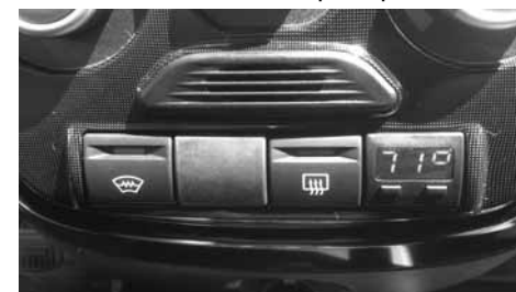
Рис.5 Вид установленного БК
