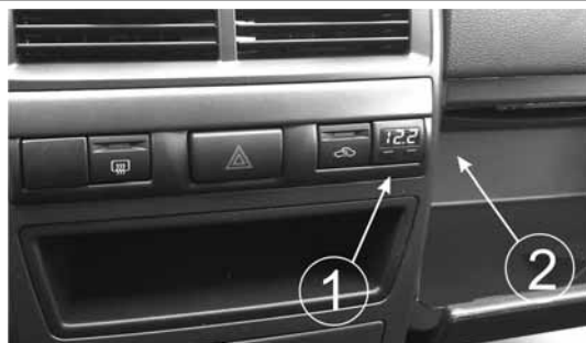
Рис.6 Вид установленного БК
