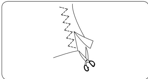
Этот стежок используется для отделки необработанного края синтетических и других тканей, которые могут морщиться. Расположите ткань так, чтобы обеспечить шов 1,6 см. После прошивки обрежьте припуск на шов. Старайтесь не порезать строчку.
