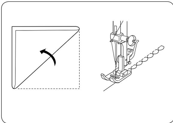
Используйте тонкую ткань (например, трикотаж). Сложите и прострочите по косой линии. Если игла отклоняется вправо, дайте ей лишь слегка коснуться сложенного края ткани. После шитья раскройте ткань и заглажьте складки на одну сторону.
