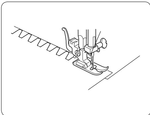
Используйте этот стежок для сшивания тканей большой толщины. Внахлест расположите необработанные края и шейте их этим стежком.
