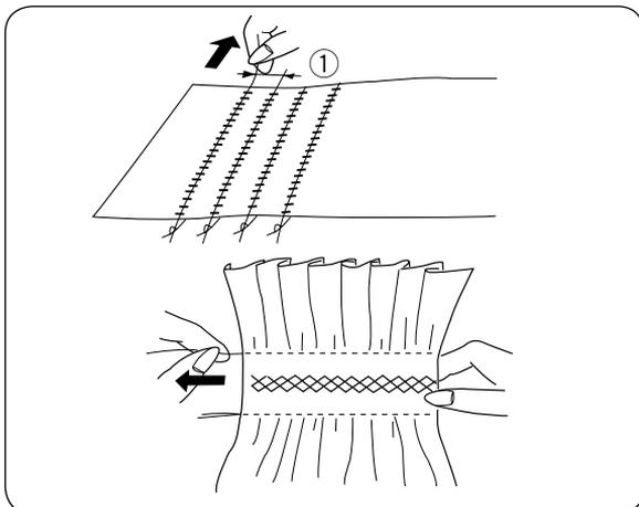
Выберите длину стежка «4», прострочите прямые строчки на расстоянии 1 см друг от друга поперек части, где будут буфы. Завяжите нитки вдоль края. Потяните за шпульные нитки, чтобы равномерно распределить складки. Зафиксируйте нитки на другом конце. Прострочите декоративный стежок между сборочными стежками. Вытяните сборочные стежки.
