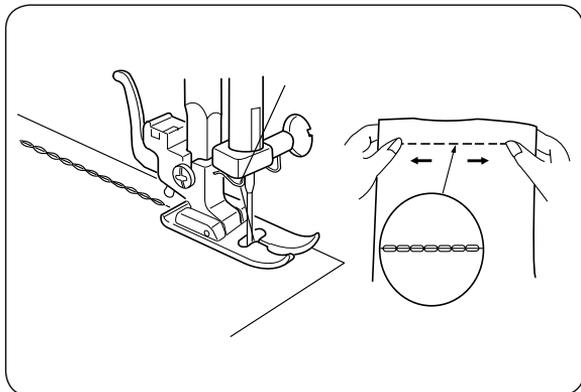
Этот прочный эластичный стежок рекомендуется применять там, где для обеспечения комфорта и прочности необходимы как эластичность, так и прочность.
