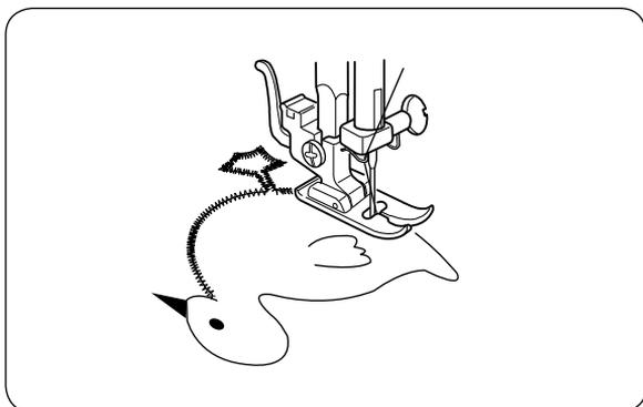
Наметайте (или наклейте термосеоднителем тканей) части аппликации на ткань. Строчите вокруг аппликации, следя за тем, чтобы игла входила вдоль внешнего края аппликации. При шитье на углах опустите иглу в ткань. Поднимите прижимную лапку и поверните ткань вправо или влево.
