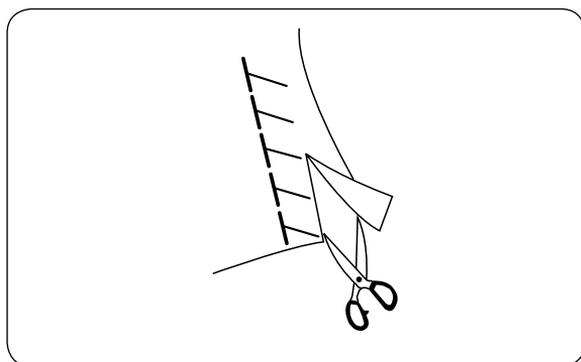
Этот трикотажный стежок идеально подходит для шитья купальных костюмов и эластичного велюра, т.к. он обеспечивает самую высокую степень эластичности и прочности. Расположите ткань так, чтобы обеспечить шов 1,6 см. После прошивки обрежьте припуск на шов. Старайтесь не порезать строчку.
