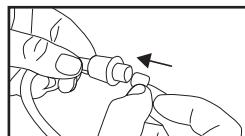
3. Setzen Sie einen Einweg-Filter in das Schlauchende.
