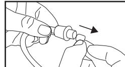
10. Po każdym użyciu należy wymienić filtr jednorazowy. W tym celu odłączyć aparat od węza. Wyciągnąć filtr jednorazowy za pomocą pincety.
