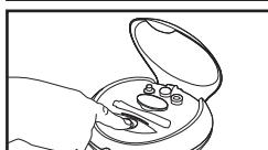
6. Para encender el aparato pulse la **tecla de encendido y apagado**. El indicador de los niveles de intensidad empieza a iluminarse. Se encuentra ya en el nivel de intensidad más bajo.
