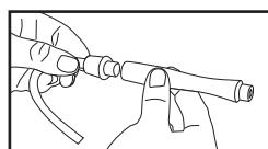
4. Verbinden Sie das Schlauchende mit dem Handgerät.
