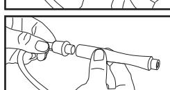
4. Podłączyć końcówkę węża do aparatu.
