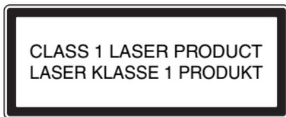
Изделие относится к 1 КЛАССУ ЛАЗЕРОВ согласно IEC60825-1:2007, 2014.
