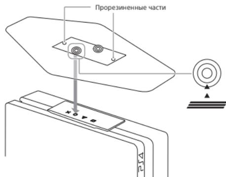
**4** Закрутите крепежный винт с помощью монеты или
